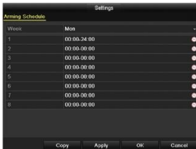
Рисунок 8.25 Установка расписания для тревожного выхода
